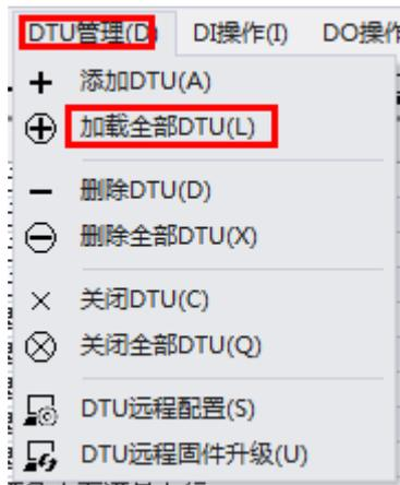
加载全部 DTU，是将数据库中存储的所有 DTU 信息全部加载到当前展示列表中，监视列表中所有 DTU 的状态，如果状态改变，将会及时存储到数据库中。
