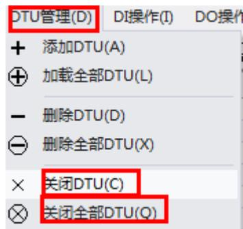
该功能将远程关闭 DTU 设备，关闭设备后，设备将会断电，不能再与服务端进行通信。
