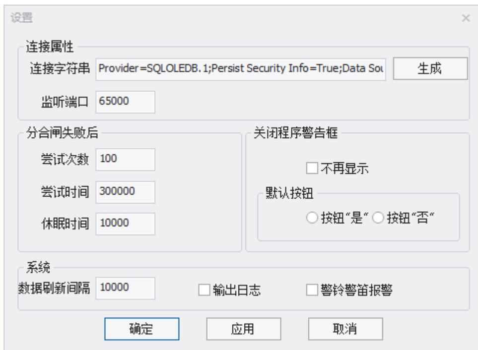
用户可以自己编写连接数据库的连接字符串，或者点击“生成”按钮，自助生成连接字符串。
